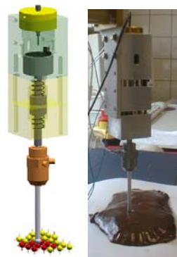
Abb. 16: Messaufbau für Impedanzmessungen an biologischem Gewebe.
