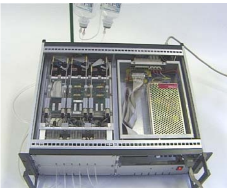
Abb. 15: Die Ansteuerung der Sonde mit 18 Kanälen.
