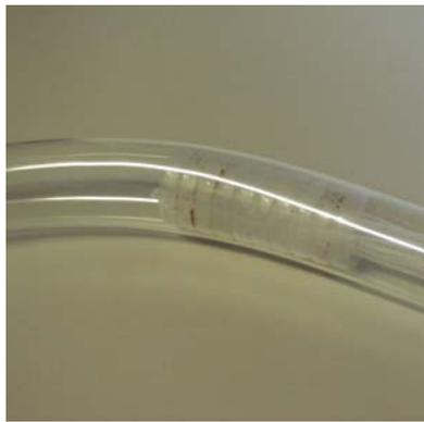
Abb. 6: Makromodell einer Silikonsonde zur Ertestung des Bewegungsprinzips
