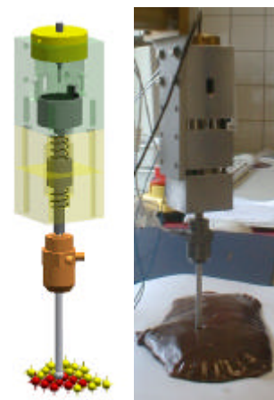
Abb. 8: Impedanzmessungen an biologischem Gewebe.
