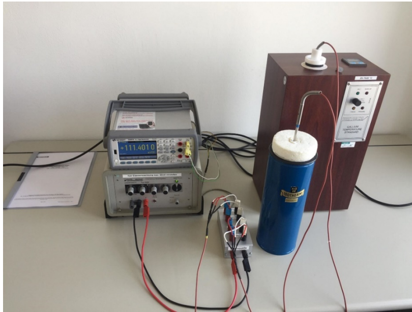
Abbildung 1: Gesamtübersicht Praktikum Teil I (Kalibrierung)
